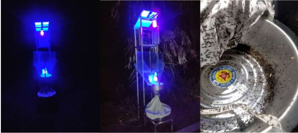
ภาพที่ 5 การติดตั้งและใช้งานเครื่องดักจับแมลงพลังงานแสงอาทิตย์ในพื้นที่
