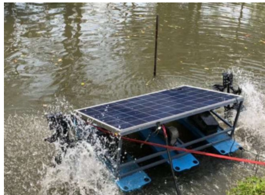
ภาพที่ 4 ต้นแบบกังหันน้ำพลังงานแสงอาทิตย์ที่สร้างขึ้น
