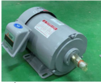
ภาพที่ 3 มอเตอร์ไฟฟ้าขนาด 2 แรงม้า (มีตชูปิซิชี รุ่น ซุปเปอร์ไลน์ เจ ซีรี่ส์ แรงดันไฟฟ้า 220/380 โวลต์ 3 เฟส)
