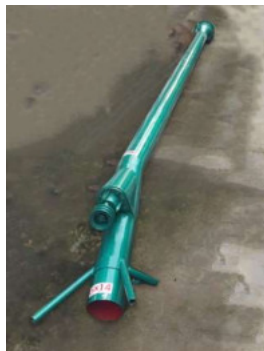
ภาพที่ 6 ท่อสูบน้ำขนาดรอบข้างขนาด 5 นิ้ว ความยาว 14 ฟุต
